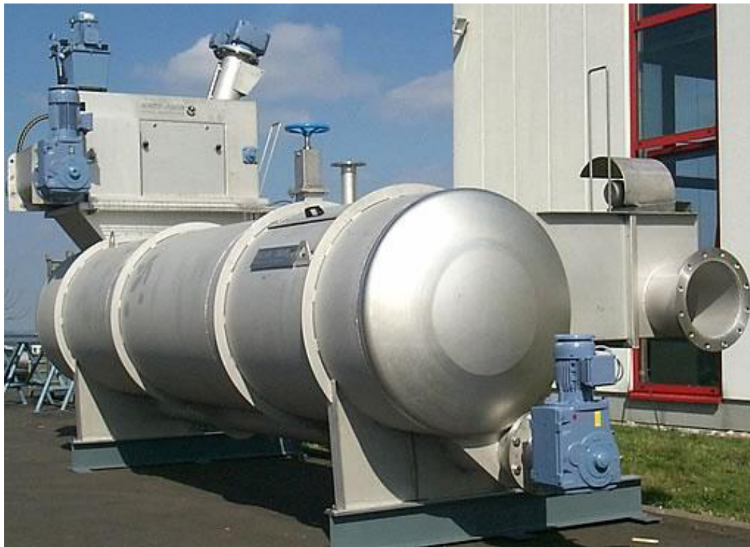
W+F válcový lapák písku kompaktní jednotka pro přítokové množství Q = 70 l/s
